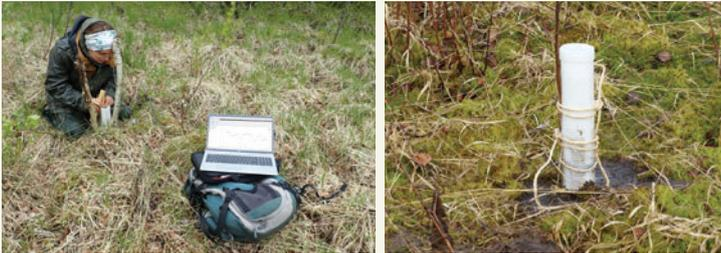
Afin de s'assurer que les niveaux d'eau sont suffisants dans les tourbières tout au long de l'année, le Conservatoire met en place des piézomètres, des dispositifs pour mesurer la hauteur d'eau, et les relève régulièrement pour pouvoir analyser les données. Les données sont enregistrées par des sondes automatiques mais aussi de façon manuelle à chaque visite sur site pour vérifier que les sondes sont toujours bien étalonnées.
