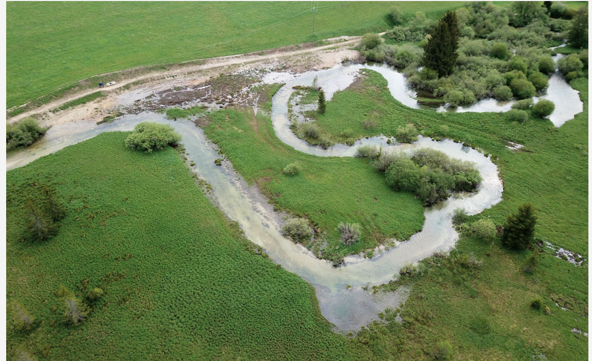
Méandre du Doubs réhabilité (mai 2018), l'ancien cours rectiligne, comblé, n'est pas encore végétalisé
