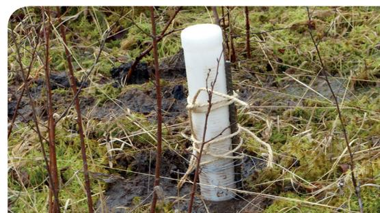
Un piézomètre a été installé en 2017 au sein du tremblant afin d'améliorer les connaissances sur le fonctionnement hydrologique du site. Cet appareil permet de surveiller les variations de niveau de nappe.
