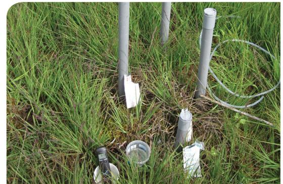
Matériel de piézométrie : une sonde est installée par un tube pvc en profondeur.
